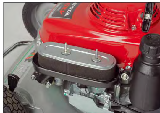
Der Schaumstoff-Luftfilter ist groß dimensioniert und auswaschbar. Ersatz ist nur selten nötig
