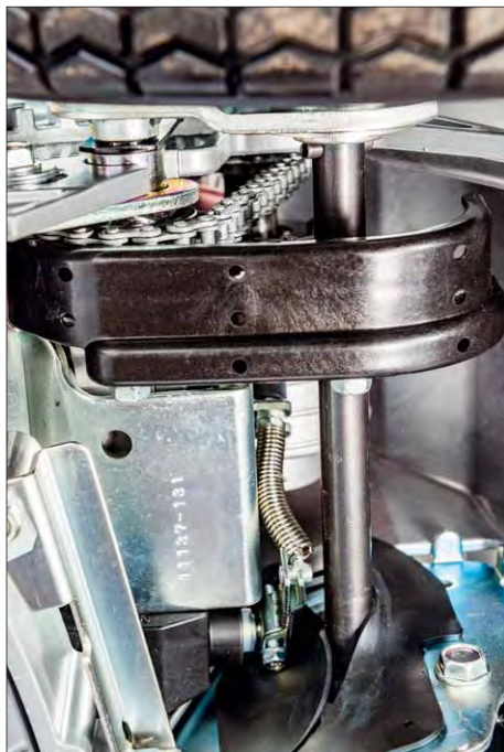
Das hydrostatische Getriebe wird über eine Kardanwelle angetrieben. Die Kraftübertragung vom Getriebe auf die Hinterachse erfolgt über eine Kette
