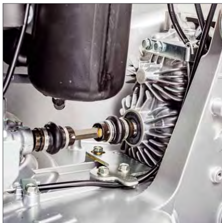
Das hydrostatische Getriebe wird über eine Kardanwelle angetrieben. Die Kraftübertragung vom Getriebe auf die Hinterachse erfolgt über eine Kette
