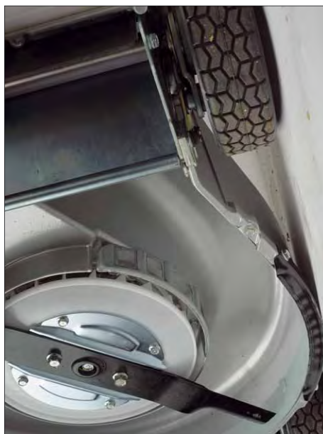
Das Lüfterrad und die in Richtung Auswurfkanal positionierten Luftöffnungen sorgen für genügend Wind unter dem Mähdeck
