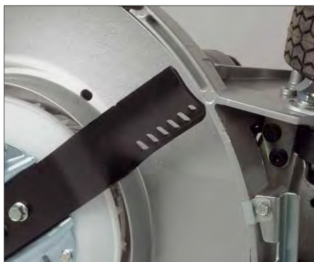
Die Löcher im Mähbalken machen durchaus Sinn, denn sie senken die durch den rotierenden Balken entstehenden Geräusche deutlich
